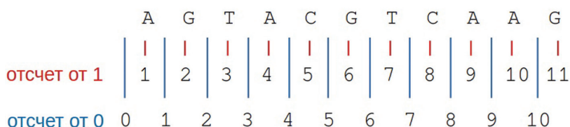
Рис. 3. Представление геномных координат в разных системах отсчета Fig. 3. Genomic coordinate systems and their frame-of-reference variations
