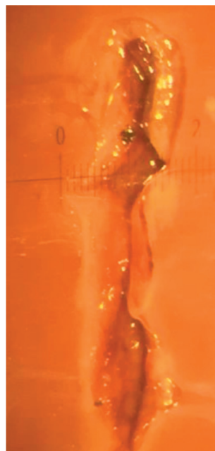
Рис. 2. Микрофотография – линейный лазерный разрез на мышечной ткани курицы (лазер 532 нм, мощность 2 Вт) с накладным измерительным стеклом ( \times 14 ). Визуализируются участки неизменной мышечной ткани в лазируемой зоне
